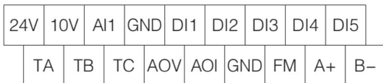
Рисунок 4-1. Схема клемм цепи управления
